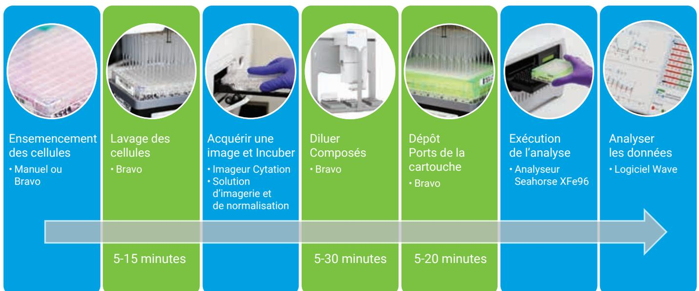
**Figure 5.** Flux de tâches général de l'analyse Seahorse XF. Les étapes de la préparation automatisée d'échantillons avec le Bravo sont illustrées en vert : lavage des cellules, préparation des solutions d'injection, et chargement des cartouches de capteurs Seahorse XFe96. Gain de temps total de 20 à 60 minutes par plateau.
